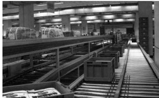
DC電源駆動モーターローラのMDRはコンピュータ制御に最適で停止精度や加速・減速・変速などの制御性に優れ、複雑な制御も対応可能です。
