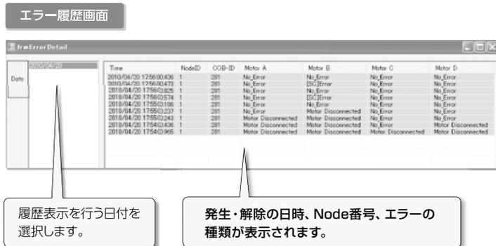
**特長 4 電流モニターにより搬送状態をチェック、故障診断やモータ交換時期を判断出来ます。**
