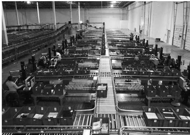
フラット直角分岐装置による高速仕分け機
